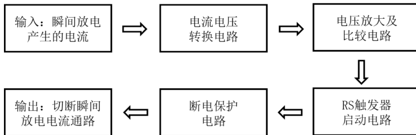
图 1 瞬间放电保护电路的结构图
