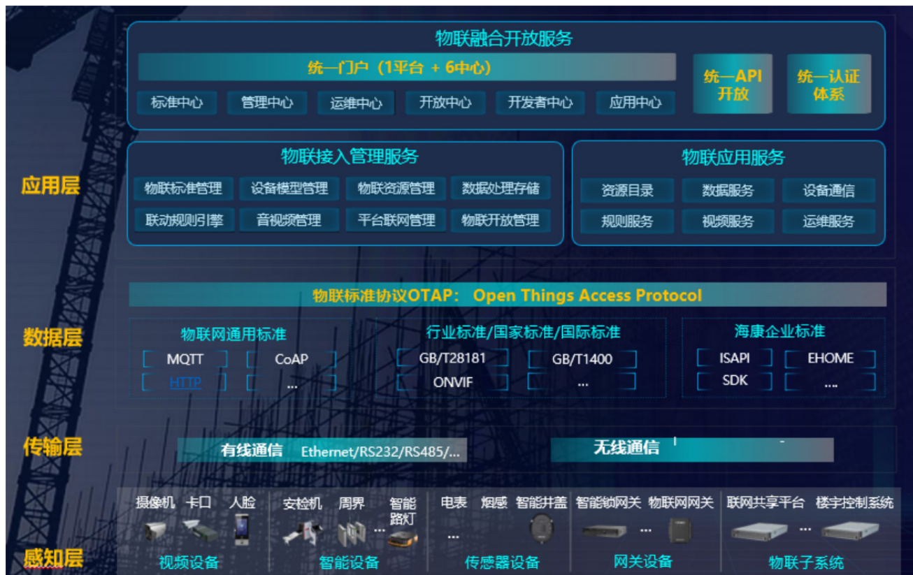
图1 智慧工地管理体系的技术架构
