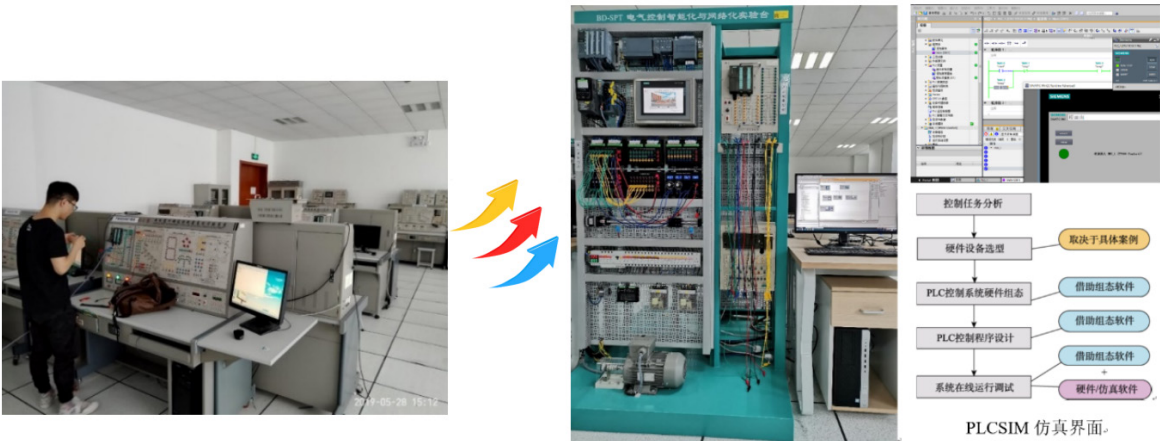
图 1 传统实验装置（左）及自研自动化技术实验台（右）
